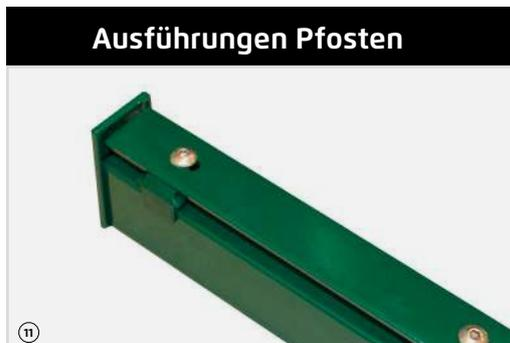
Die Pfosten des System Sencilo Life bestehen aus stabilen Rechteckrohren mit einem Profil von 80 x 40 mm. Ab einer Zaunhöhe von 2230 mm haben die Pfosten ein Profil von 120 x 40 mm. Die Pfosten haben als Montagepunkt eine durchgehenden Abdeckleiste die an vormontierten Kunststoffgeräuschdämmern montiert wird.
