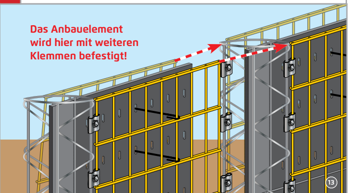
2 Anbauelement noch nicht montiert!
