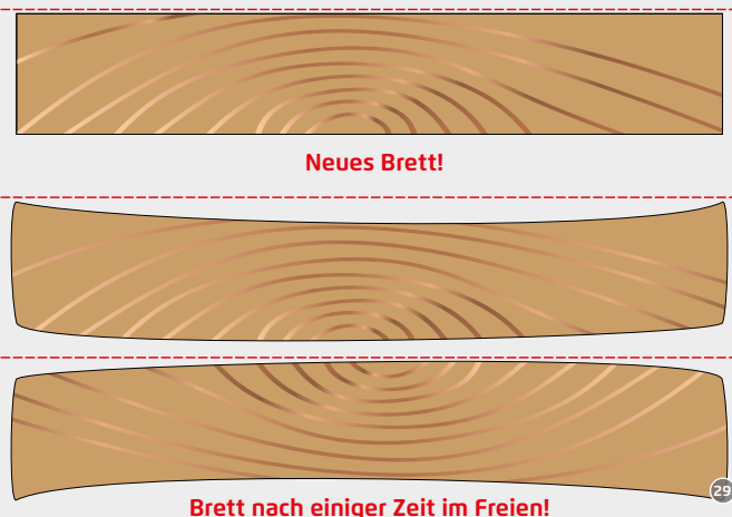
Abb. 13 Holz arbeitet und verändert seine Form!
