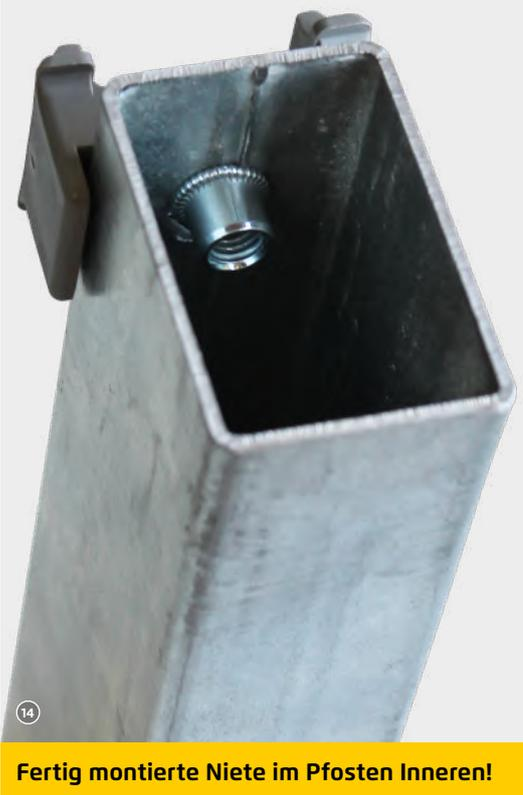
**Fertig montierte Niete im Pfosten Inneren!**
