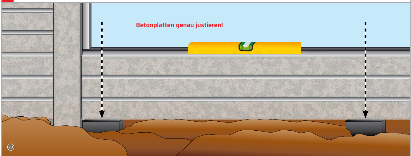
7 Auf beiden Seiten Pflasterstein unterlegen und Platten waagrecht auflegen!
